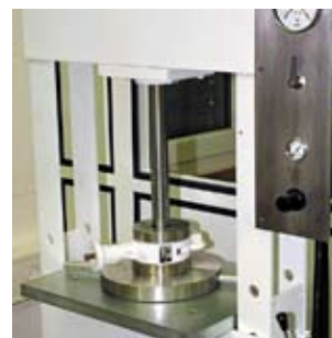
Испытание на герметичность высокочистым азотом
